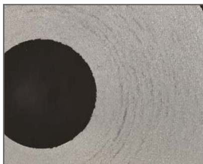
Угол наклона 6° – Rz 11.3 μm
