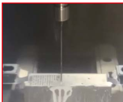
Время обработки 8 с/отверстие
