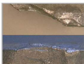
Трещина после обработки в течении 210 секунд
